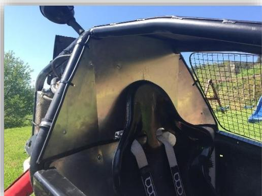
En la imagen adjunta se ha instalado la parte superior como elemento adicional a la placa de separación ya existente y que se puede apreciar que llegaba hasta la altura de los hombros del piloto aproximadamente.
